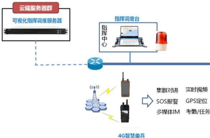
单兵通信调度系统提供了无距离限制的语音集群对讲，实现丰富的多媒体功能，支持多媒体消息，视频图片上报及实时视频回传等功能，让对讲有了新体验。该系统用的优点在于：
