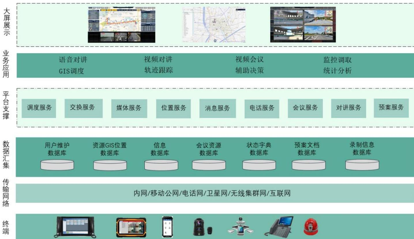
■**指挥层**：系统可以为用户提供多种表现方式，如触摸屏一体化调度台、普通PC机、一机多屏PC、移动调度台等PC应用终端。
